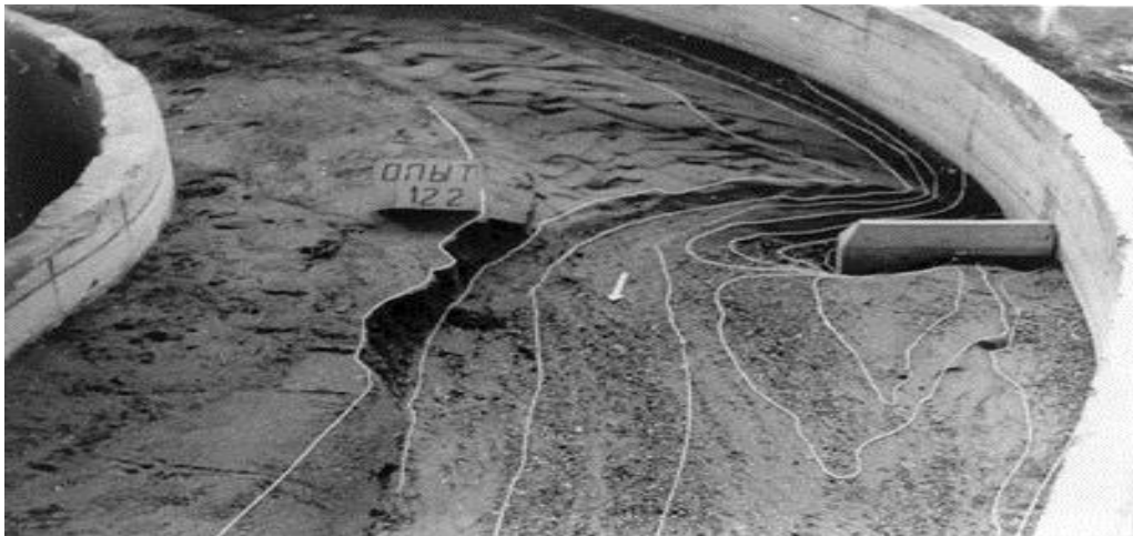
ფოტო. 1. დეზი ბეტონის სწორკუთხე მასივებისაგან ლარის II უბანზე. B=60 სმ, Q=6 ლ/წმ. ნახაზზე ნაჩვენებია საწინააღმდეგო ნაპირის წარეცხვის კონტური
