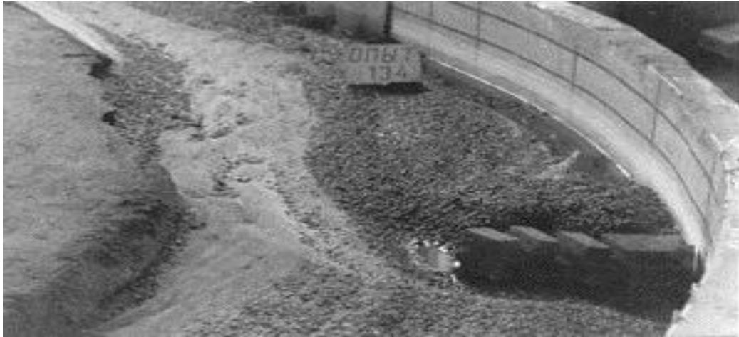
ფოტო. 1. დეზი ბეტონის სწორკუთხე მასივებისაგან ლარის II უბანზე. B=60 სმ, Q=6 ლ/წმ. ნახაზზე ნაჩვენებია საწინააღმდეგო ნაპირის წარეცხვის კონტური
