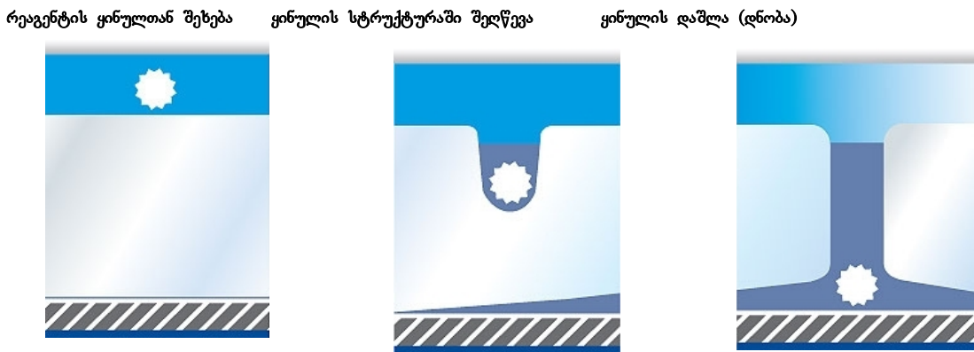
სურათი №1. რეაგენტის მუშაობის პრინციპი
